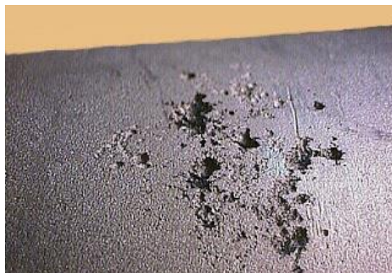
Slika 14. Preklapanje jamičastih udubljenja [24] .
