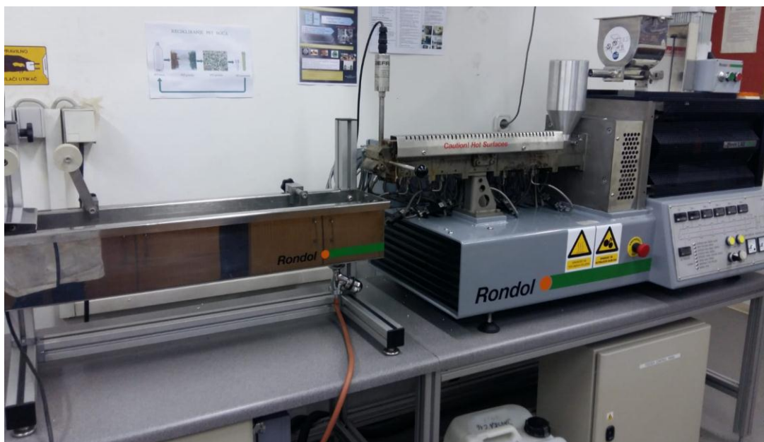
Slika 22. Dvopužni ekstruder Rondol 21 mm LAB TWIN
