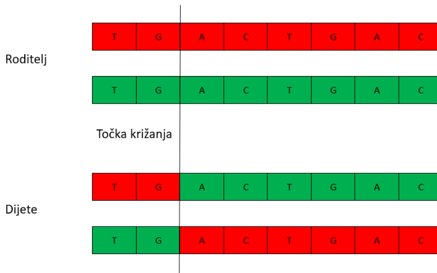
Slika 5: Križanje u jednoj točki
