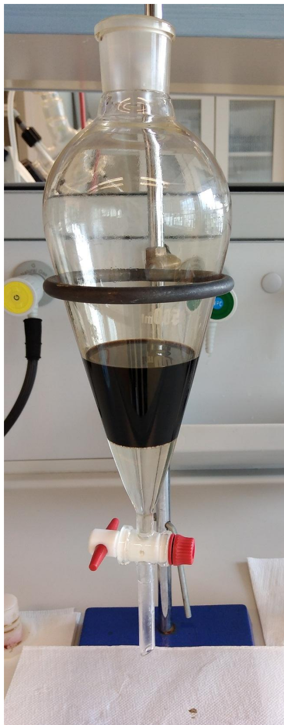
Slika 6. Odvojeni kloroformski (dolje) i vodeni (gore) sloj u lijevku za odjeljivanje (autorica fotografije: Renata Odžak)
