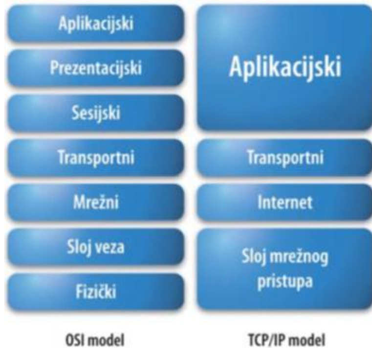
Slika 2. Razlika OSI i TCP/IP modela po slojevima [1]
