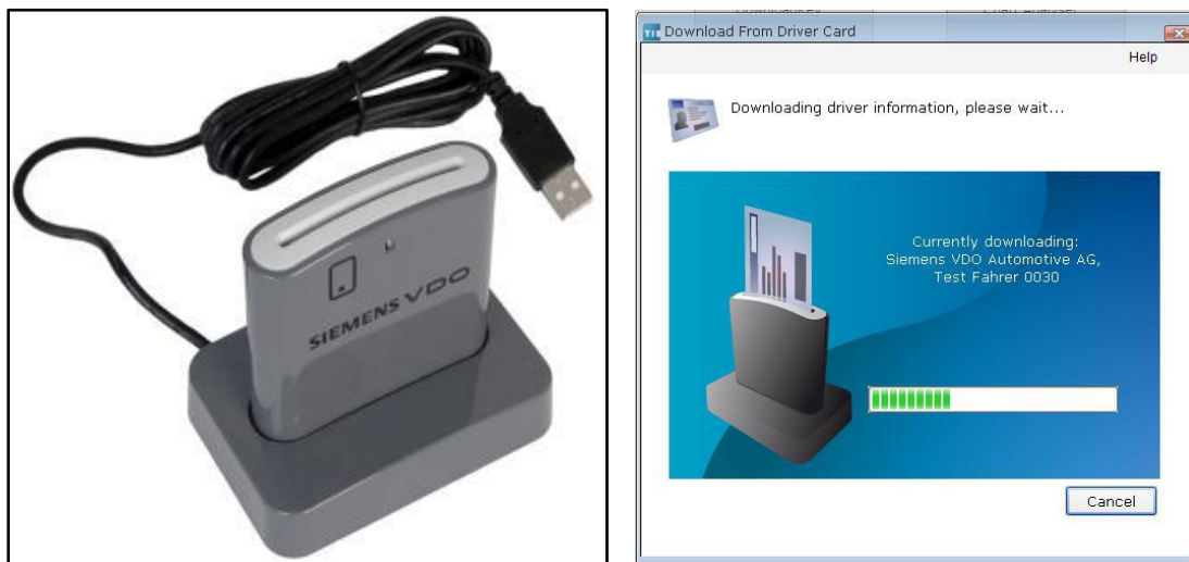
Slika 31.– Čitač kartica vozača i prijenos podataka na TIS-Web server [16]
