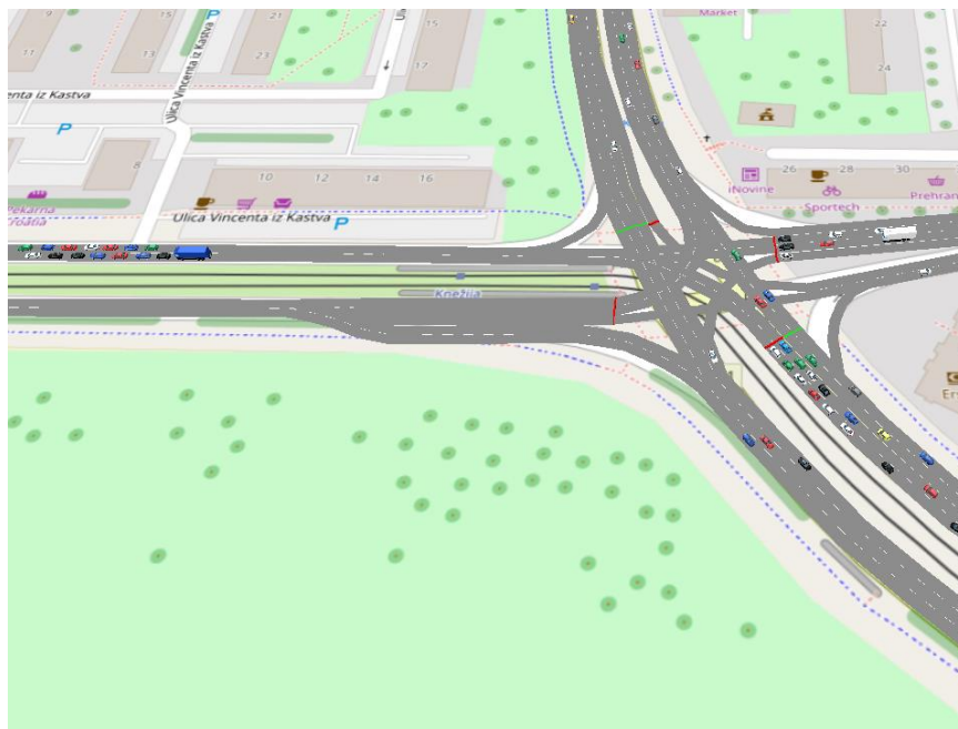
Slika 29 Isječak iz simulacije postojećeg stanja mreže na raskrižju Selska cesta - Horvaćanska cesta
