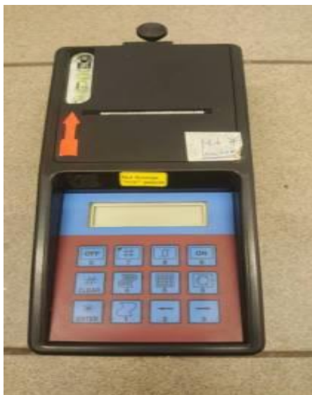
Slika 30. Mjerač usporenja (decelerometar) MAHA VZM 100
