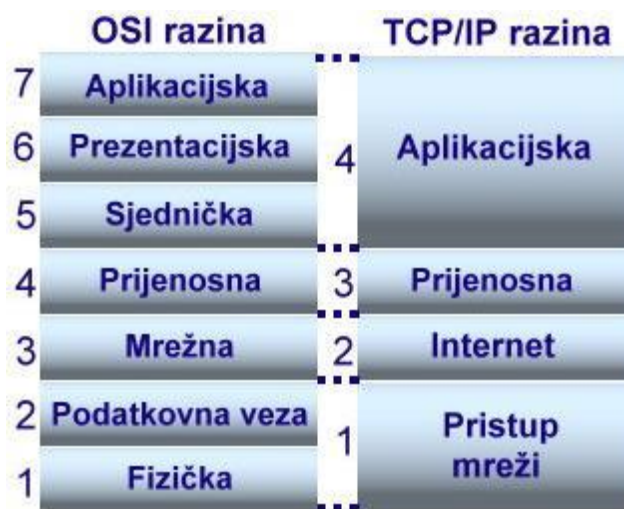
Slika 5. Odnos OSI modela i TCP/IP arhitekture, [8]
