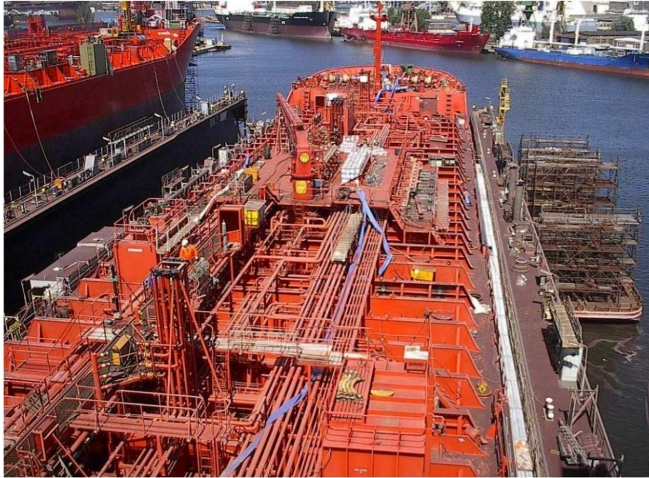
Slika 10. Paluba tankera za prijevoz kemikalija
