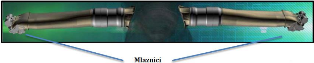
Slika 28 - Postave za rotaciju STOVL motora [10]
