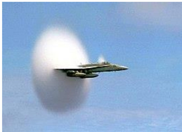
Slika 21. Probijanje zvučnog zida [15]
