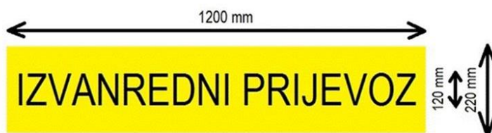
Slika 23: Dimenzije oznake izvanrednog prijevoza
