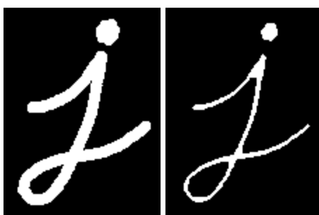
Slika 17: Rezultat primjene postupka erozije [40]
