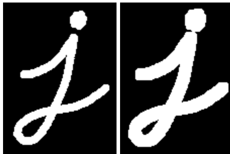
Slika 18: Rezultat primjene postupka dilatacije [40]
