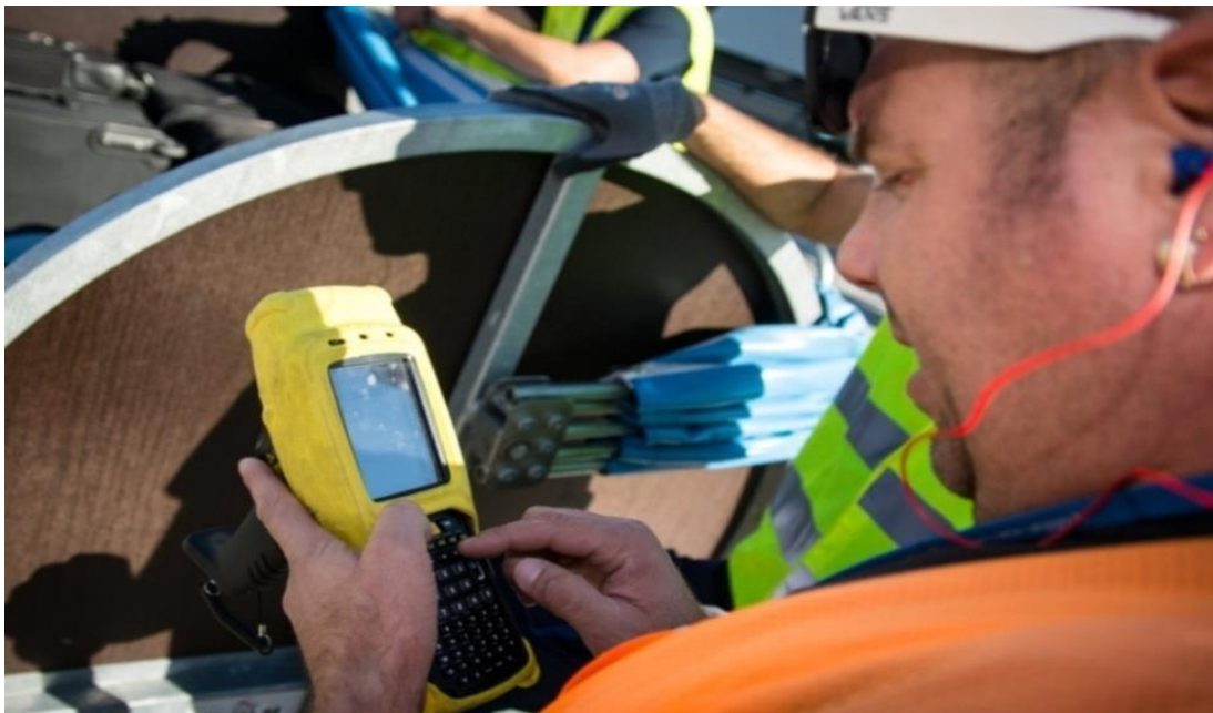
Slika 9. PDA uređaj za praćenje utovara zrakoplova, [13]
