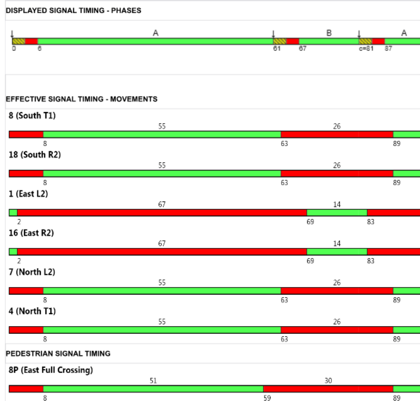
Slika 47 Signalni plan raskrižja 2 – Varijanta 1, Sidra Intersection
