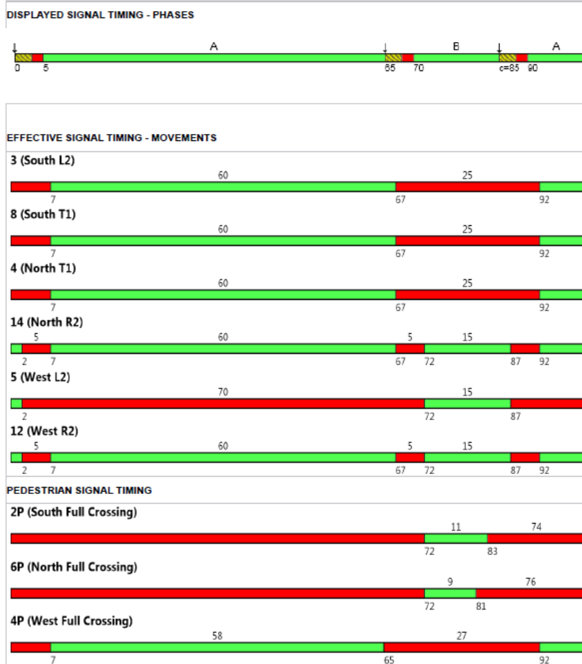
Slika 56 Signalni plan raskrižja 5 – Varijanta 2, Sidra Intersection
