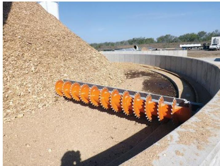
**Slika 46. Linearni sustav uređaja za povrat s pužnim transporterom sa dovodnom cijevi**
