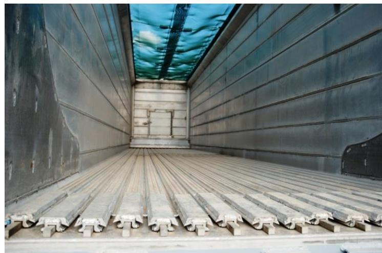
**Slika 43. Sustav uređaja za povrat s hodajućim dnom**
