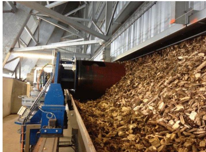
**Slika 47. Kružni sustav uređaja za povrat s pužnim transporterom sa dovodnom cijevi**
