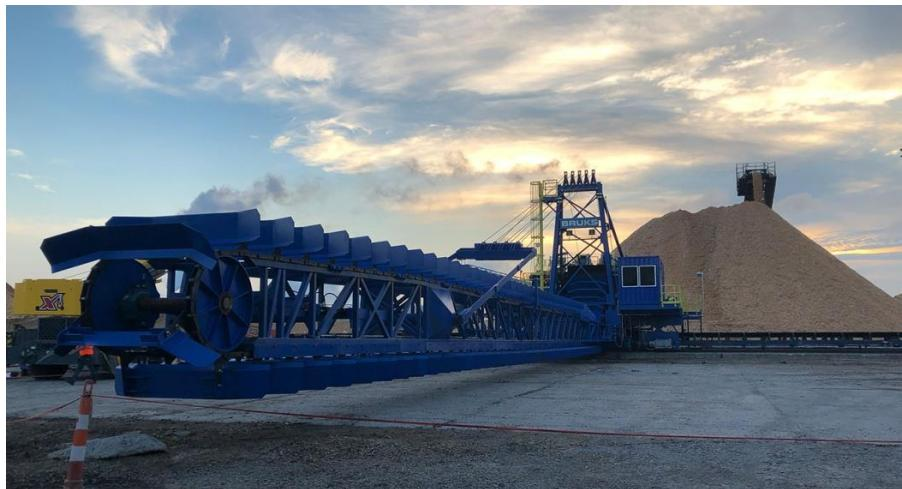
**Slika 48. Sustav uređaja za povrat s trakastim transporterom**
