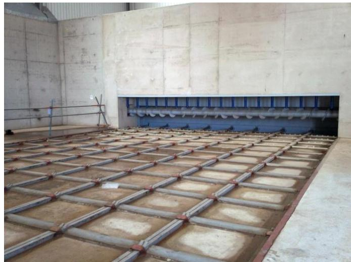
**Slika 42. Sustav uređaja za povrat s gurajućim dnom**
