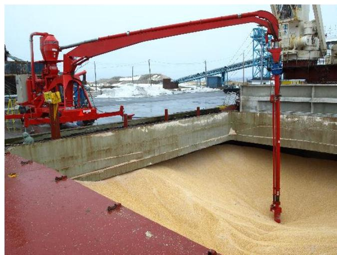
**Slika 25. Brodski vakuumski iskrcavač**
