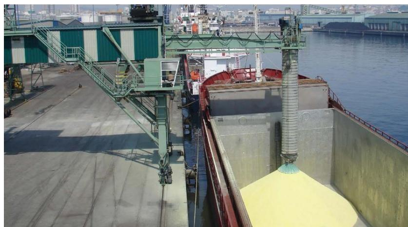
**Slika 56. Brodoukrcavač s dovodnom cijevi sa žlijebom**
