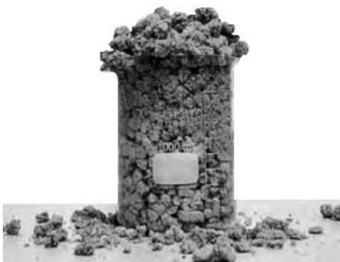
Slika 70. Problem rasta skladišne hrpe peleta
