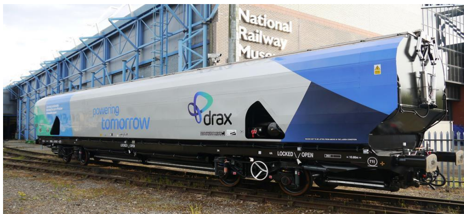
Slika 53. Željeznički vagon za transport kruto rasute biomase
