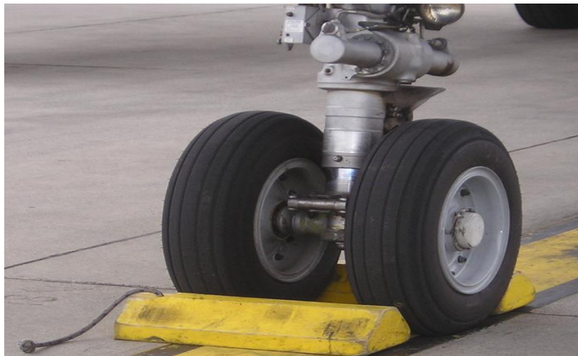
Slika 2. Podmetači podmetnuti pod kotače zrakoplova [16]
