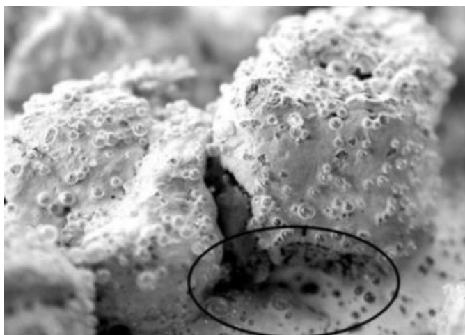
Slika 23. Nepokrivenost hrapave podloge materijalom
