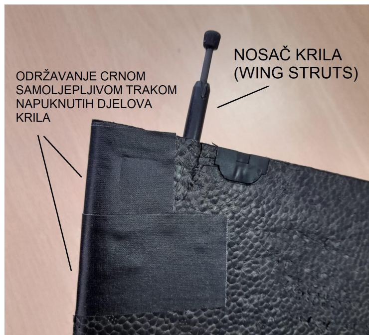
Slika 7. Prikaz održavanja krila pomoću samoljepljive trake.
