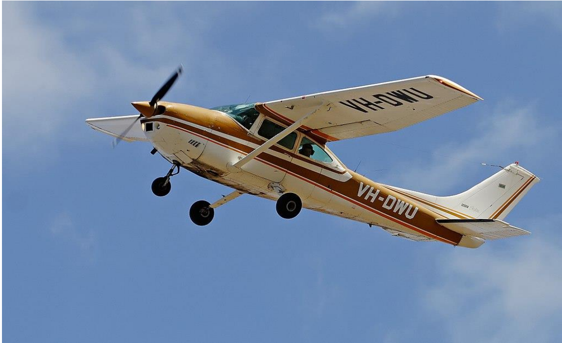
Slika 17. Natpisi nacionalne i registracijske oznake zrakoplova na trupu i ispod krila, [21]
