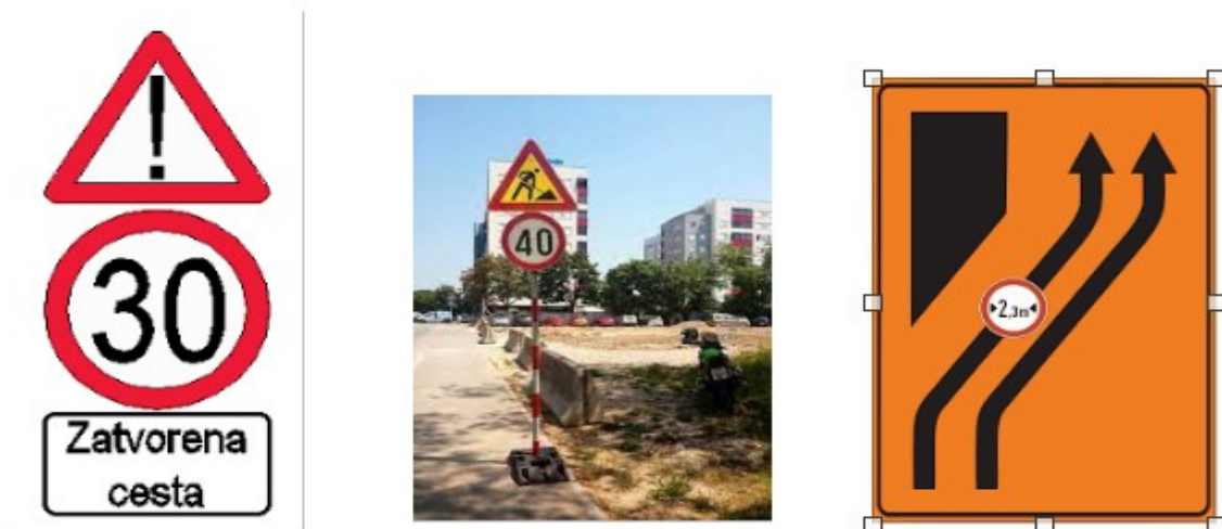
Slika 15. Primjer znakova za privremenu regulaciju prometa
