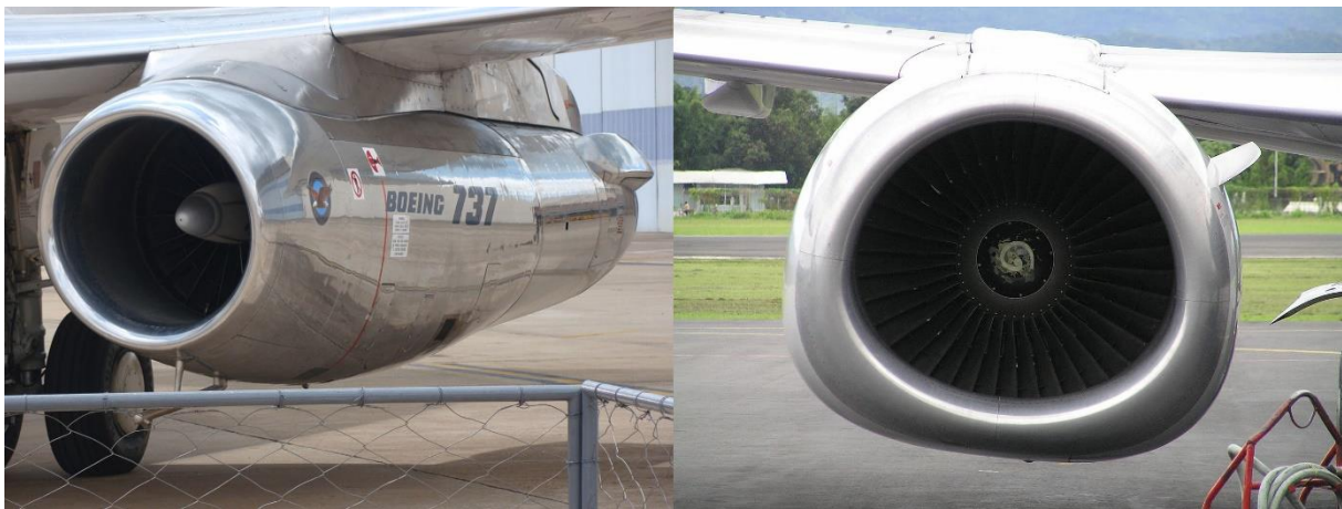
Slika 4. Razlika između gondole Boeinga 737-200 (lijevo) i 737-300 (desno), [11], [12]
