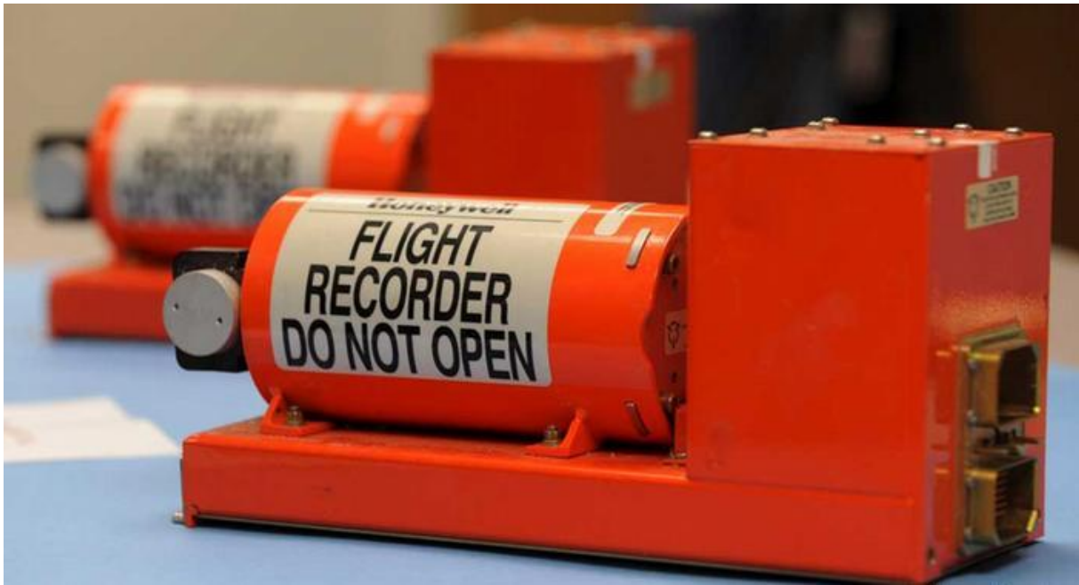
Slika 10. Snimač podataka o letu, [40]
