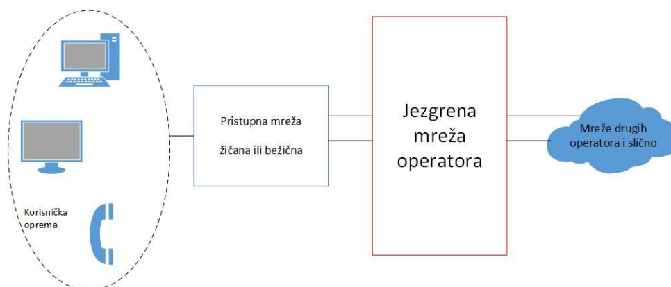
Slika 1. Segmentacija telekomunikacijske mreže. Podatci od [2].
