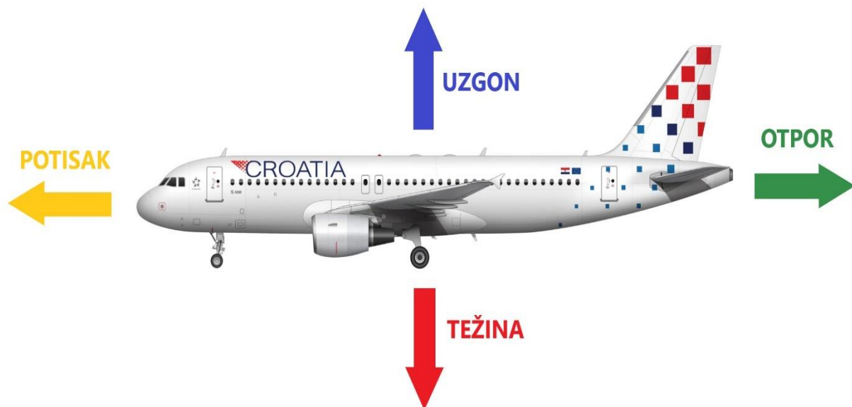
Slika 4. Četiri osnovne aerodinamičke sile koje djeluju na zrakoplov u letu
