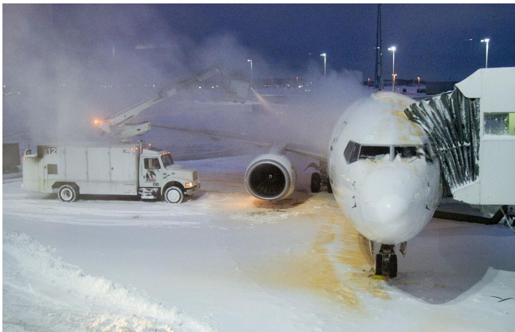
Slika 12. Proces odleđivanja zrakoplova na poziciji opremljenoj avio-mostom Izvor: [18]
