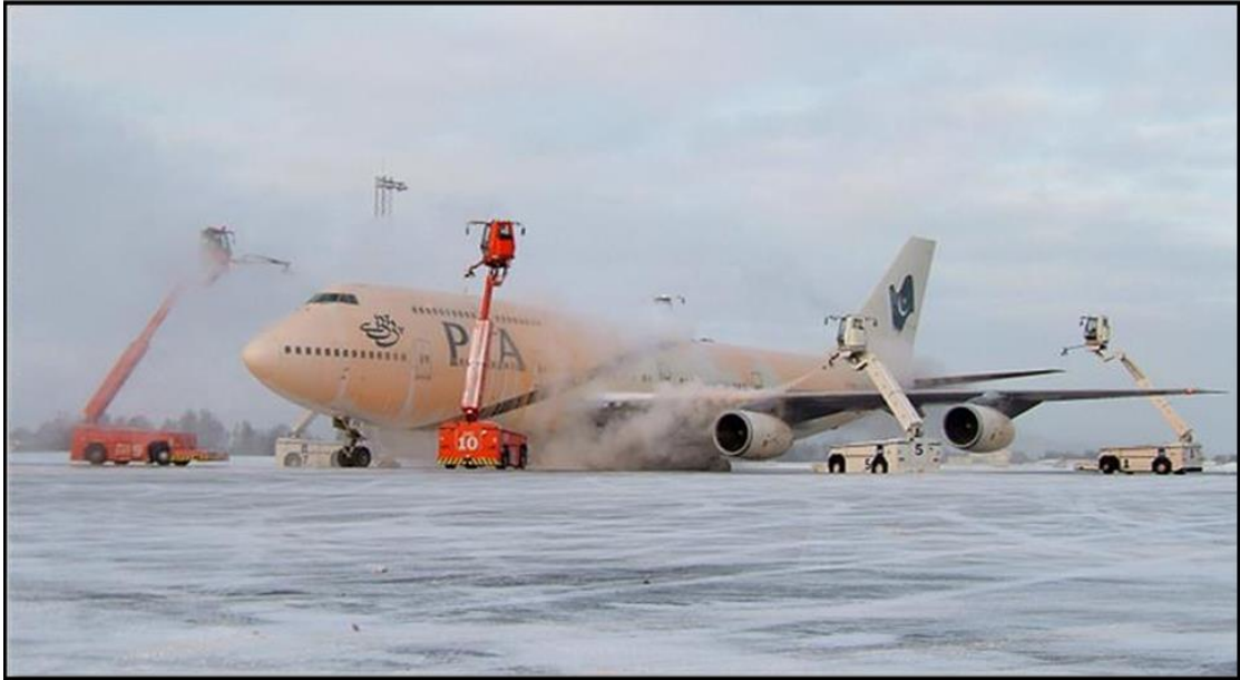
Slika 11. Izdvojena stajanka za odleđivanje zrakoplova Izvor: [2]
