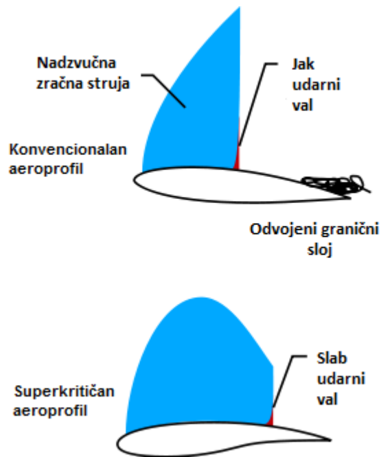
Slika 25: Konvencionalan i superkritičan aeroprofil [7]
