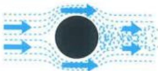
Slika 4: Odvajanje protoka zraka od cilindra [1]
