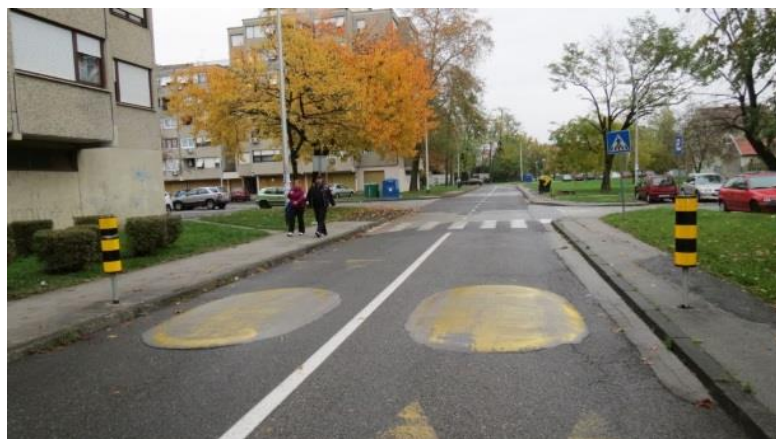
Slika 56. Primjer dobrog uspornika koji omogućava nesmetan prolazak biciklista Izvor: [19]
