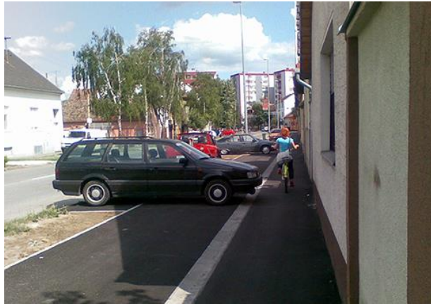
Slika 14. Nepovoljno vođenje biciklističkog traka uz parkirana vozila
