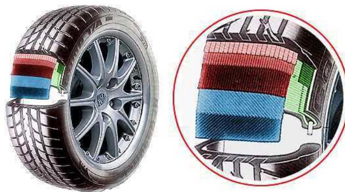
Slika 4. Sastavni dijelovi radijalnog pneumatika, [7]
