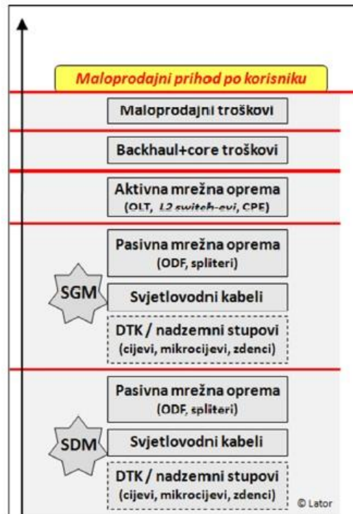
Slika 13. - Struktura jediničnih troškova FTTH operatora – idealni ekonomski održivi slučaj [2]
