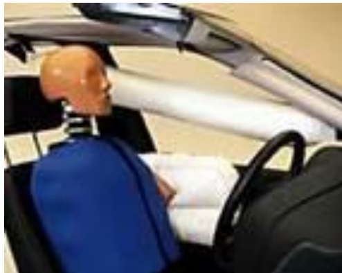
Slika 17. Bočni zračni jastuci [30]
