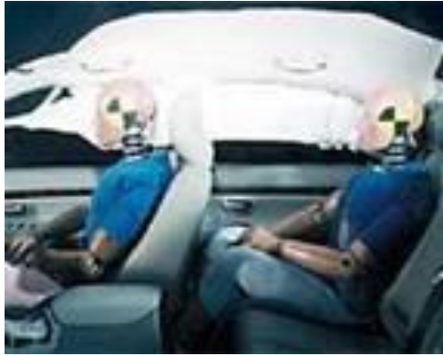
Slika 16. Bočni zračni jastuci [30]
