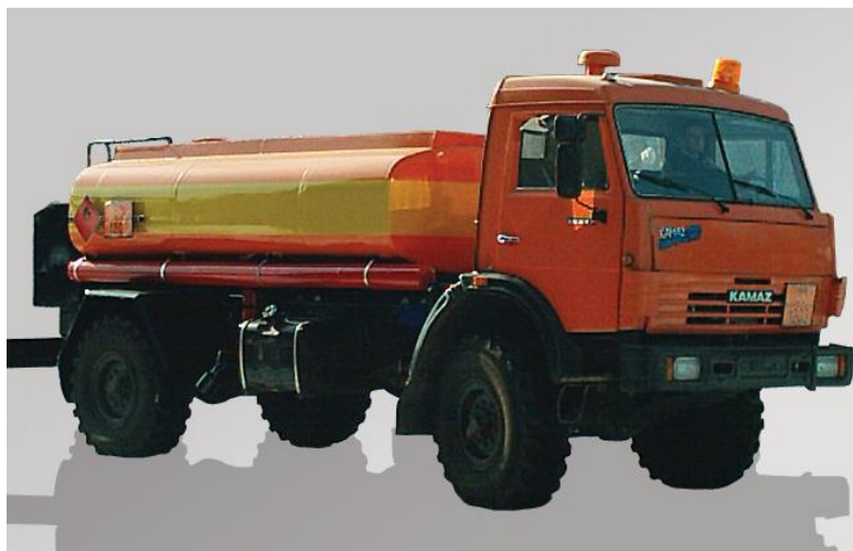
Slika 8: Cisterna za prijevoz goriva tipa VCG-5
