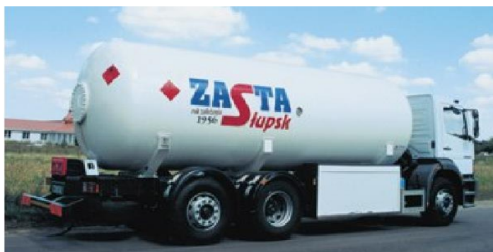
Slika 4: Pokretni spremnik za prijevoz LPG-a
