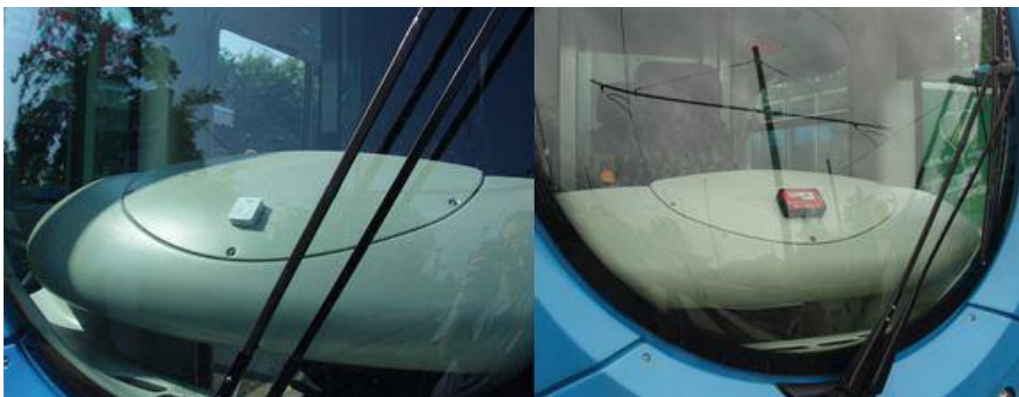
Slika 18. Položaj GPS uređaja u tramvaju
