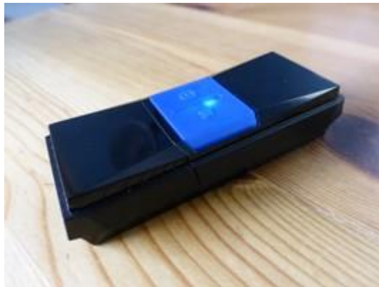
Slika 17. Uređaj GPS Logger gt-740fl
