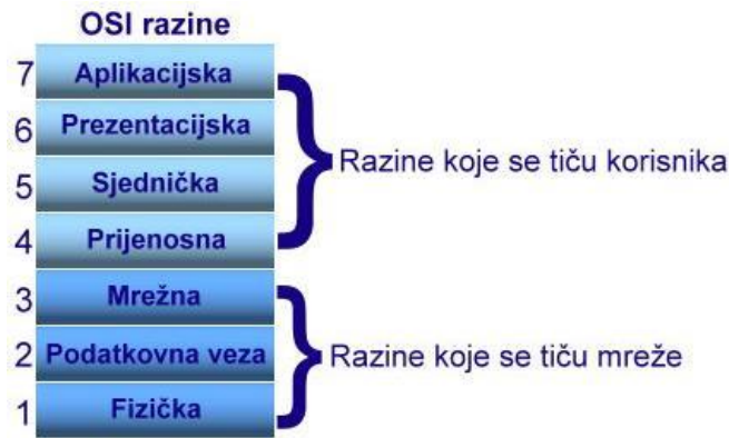
Slika 2. OSI referentni model, [6]
