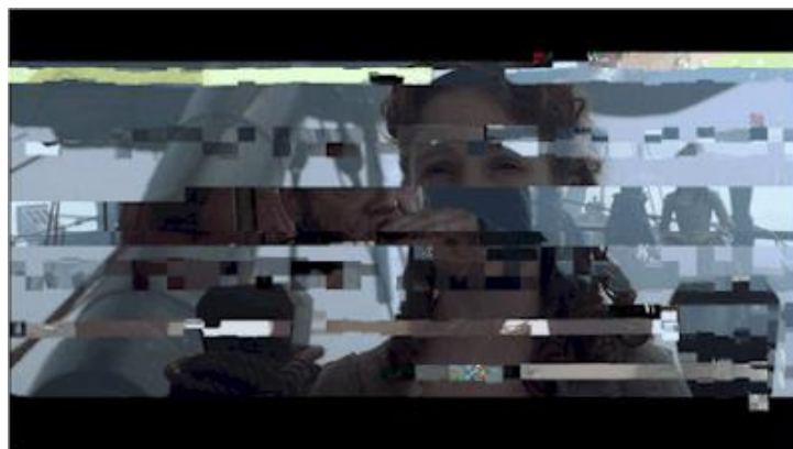
Slika 11. Nepravilan prikaz slike nakon gubitka paketa [28]
