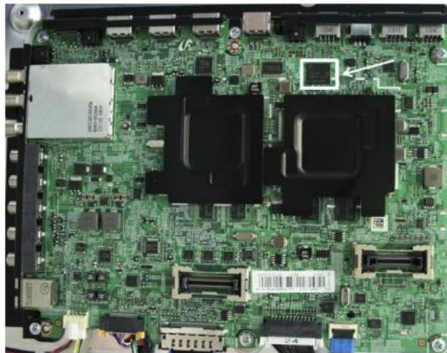
Slika 9: Prikaz matične ploče Samsung SmartTV -a, [47]
