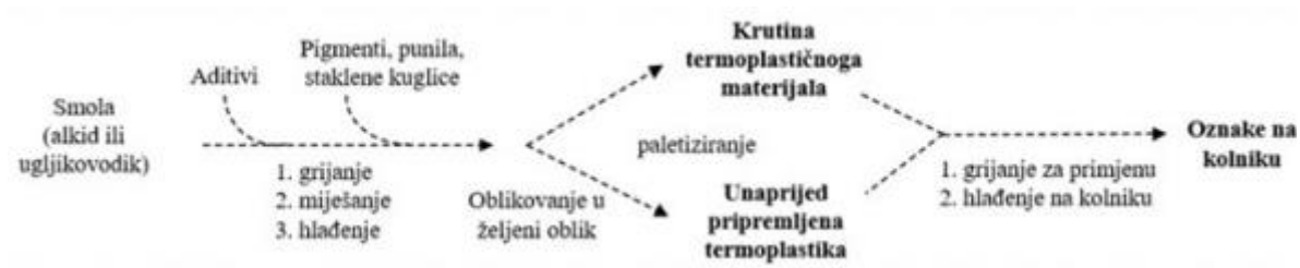
Slika 2. Postupak dobivanja oznaka putem termoplastike
