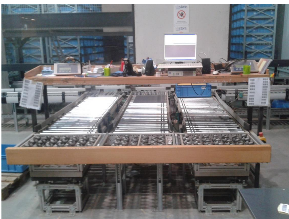
Slika 9. Upravljački pult robotiziranog skladišta
