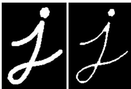
Slika 17: Rezultat primjene postupka erozije [40]
