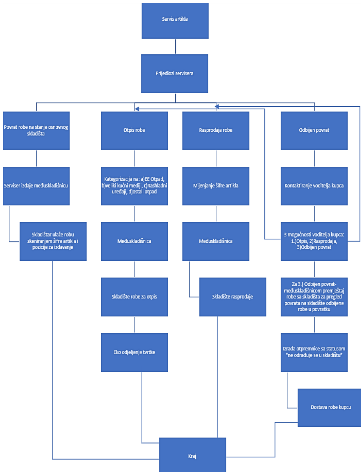
Slika 9. Prikaz postupka s robom nakon obrade u servisu
