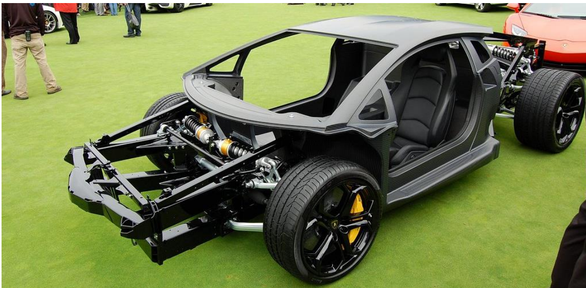
Slika 21: Nosivi okviri Lamborghini Aventador
