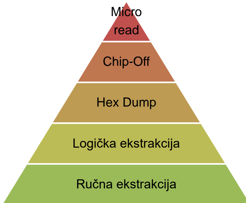
Slika 8. Usporedba brzine ekstrakcije i količine dobivenih podataka, [34]
