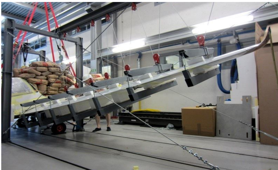
Slika 13. Testiranje konstrukcije zrakoplova na opterećenje savijanjem
