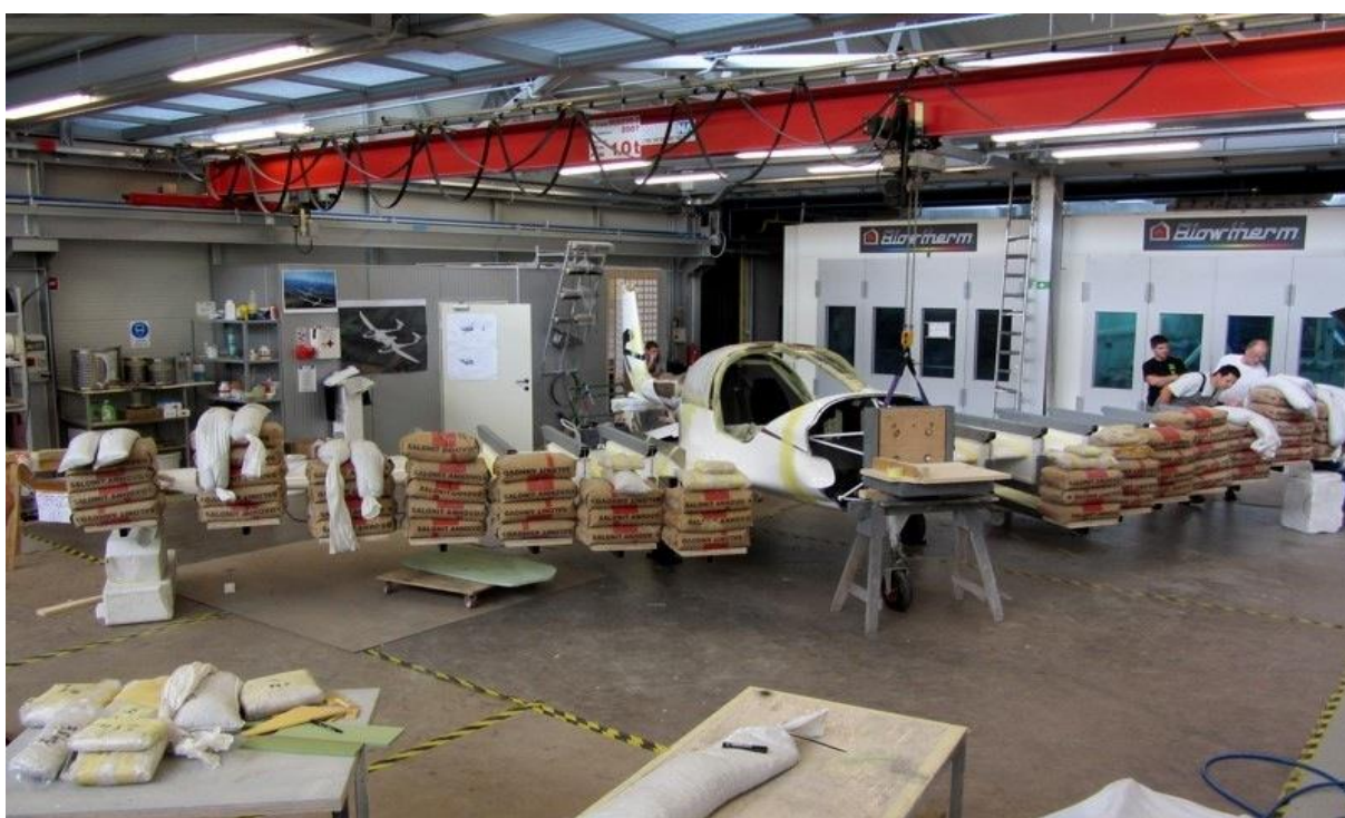
Slika 14. Ispitivanje statičke čvrstoće konstrukcije
