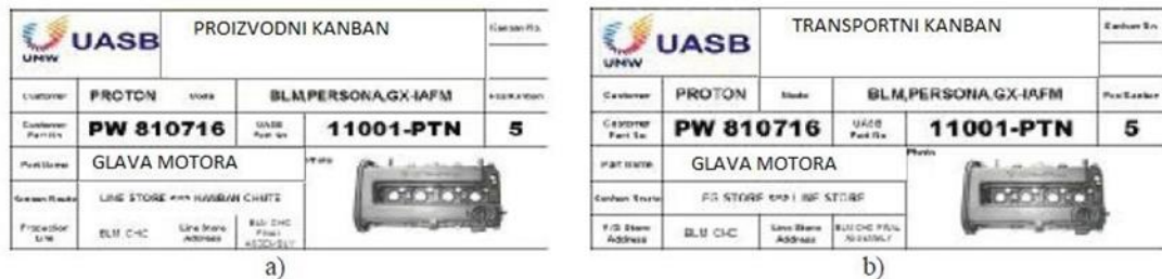
Slika 7. Primjer Kanban kartica; a) Kartica za proizvodni Kanban b) Kartica za transportni Kanban
