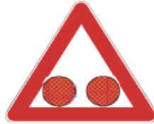
Slika 19. Svjetlosni znak za označavanje i upozoravanje na prijelaz ceste preko pruge
