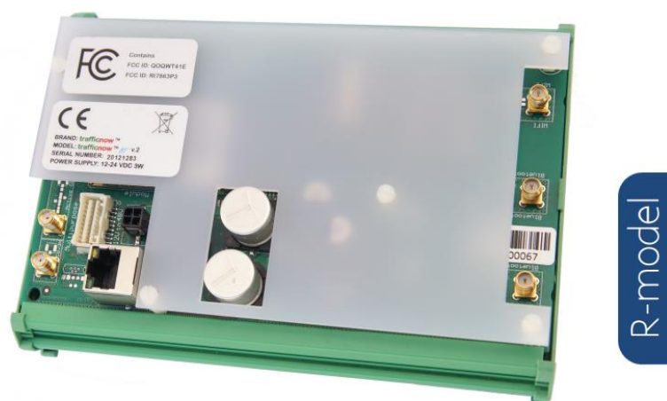
Slika 4. DeepBlue R-model v2t senzor [11]
