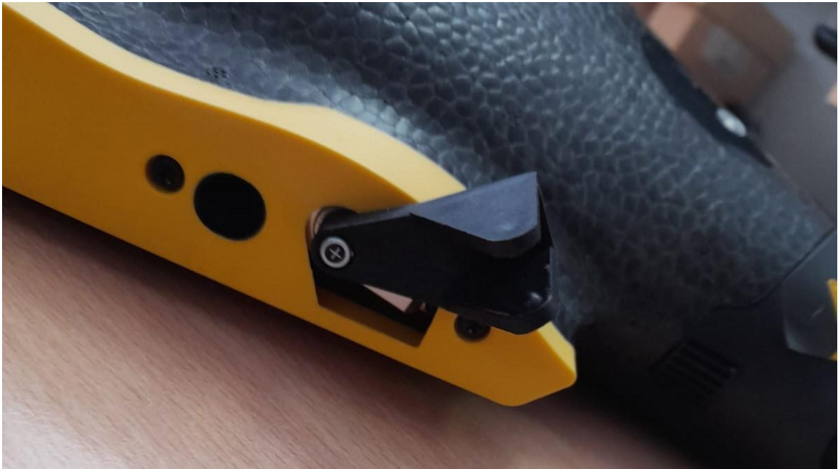
Slika 6. Servo mehanizam za upravljanje zakrilcima zrakoplova.
