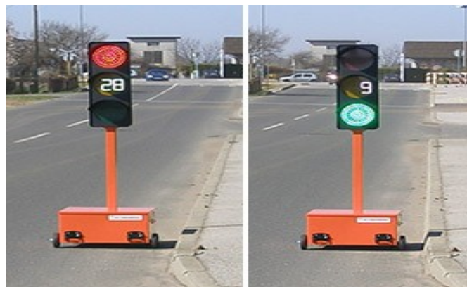
Slika 17. Pokretni semafori uređaji
