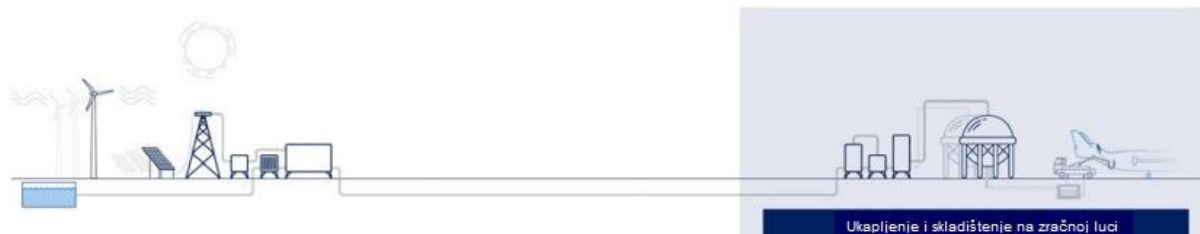
Slika 8. Opcija 2. vodik koji se proizvodi izvan mjesta, isporučuje se zračnoj luci plinovodnom i ukapljuje se na zračnoj luci, (34)
