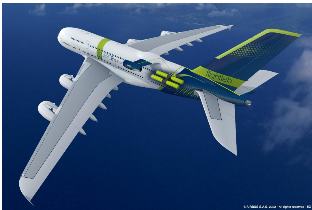
Slika 6. Položaj spremnika tekućeg vodika u zrakoplovu, (36)
