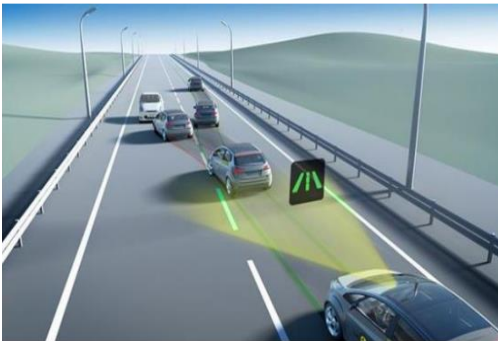
Slika 18. Prikaz aktiviranja LKA sustava
