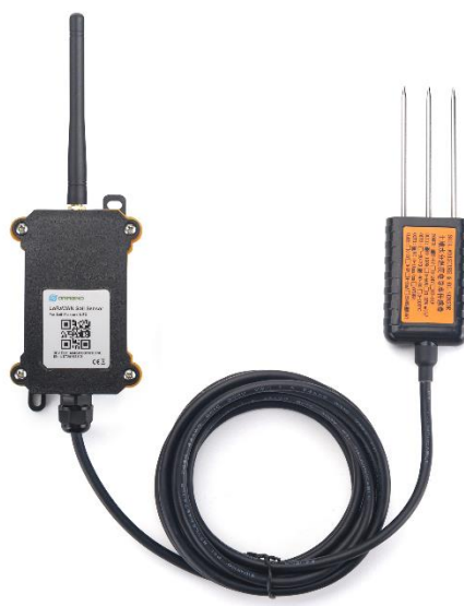
Slika 21. Dragino LSE01 senzor vlage u tlu
