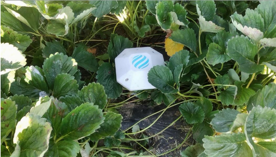
Slika 23. RSMT3L senzor vlage i temperature
