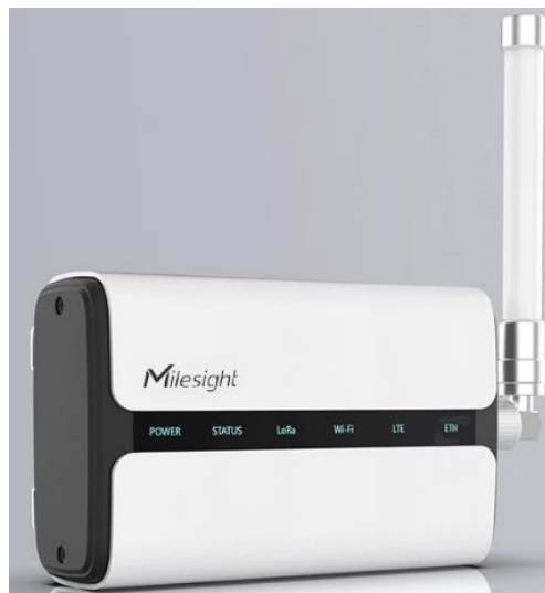
Slika 16. UG65 LoRa WAN pristupnik [19]
