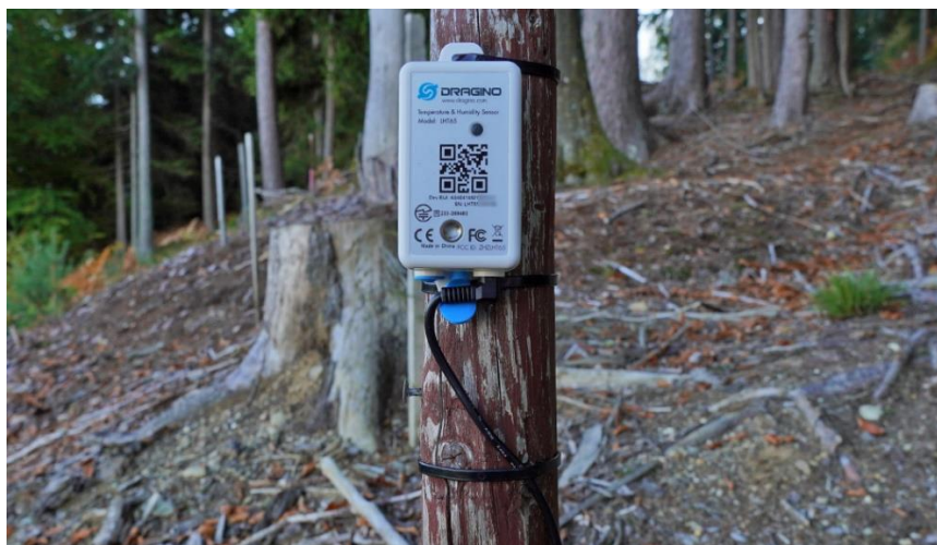
Slika 22. Dragino LHT65 senzor temperature i vlage
