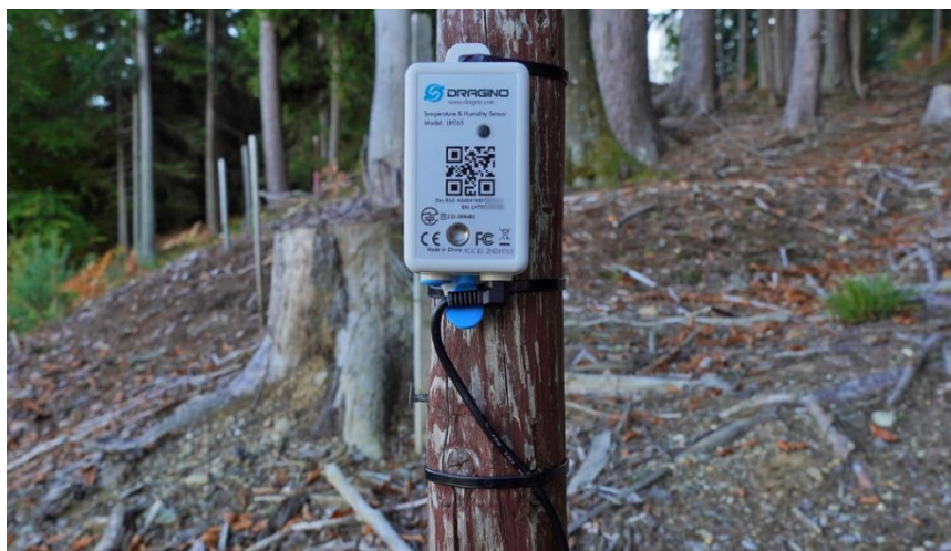
Slika 22. Dragino LHT65 senzor temperature i vlage
